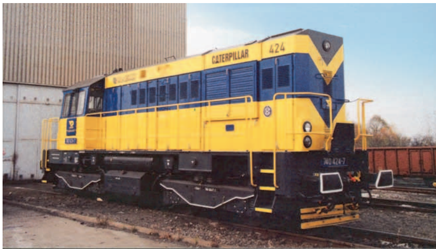
V roce 1998 byla modernizována dieselelektrická lokomotiva 740 424-7 v barvách OKD, Doprava s motorem Caterpillar
